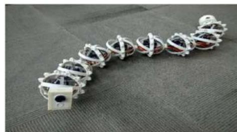
Figura 8: Projeto conceitual e modelo físico do robô HITSZ-Snakebot II.
