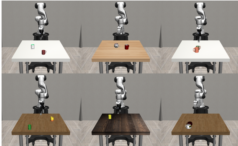
Figura 8: Diferentes instâncias de uma tarefa de manipulação no robosuite. Em cada imagem, o modelo de garra, o modelo e número de canecas, a textura da mesa, as posições e orientações dos objetos são randomizadas. Fonte: Elaborada pelo Autor.
