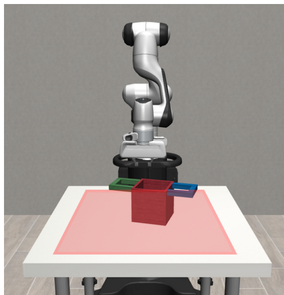
Figura 12: Ambiente da tarefa Pot With Handles. A região vermelha mostra os possíveis locais de posicionamento do objeto de forma aproximada. Fonte: Elaborado pelo Autor.
