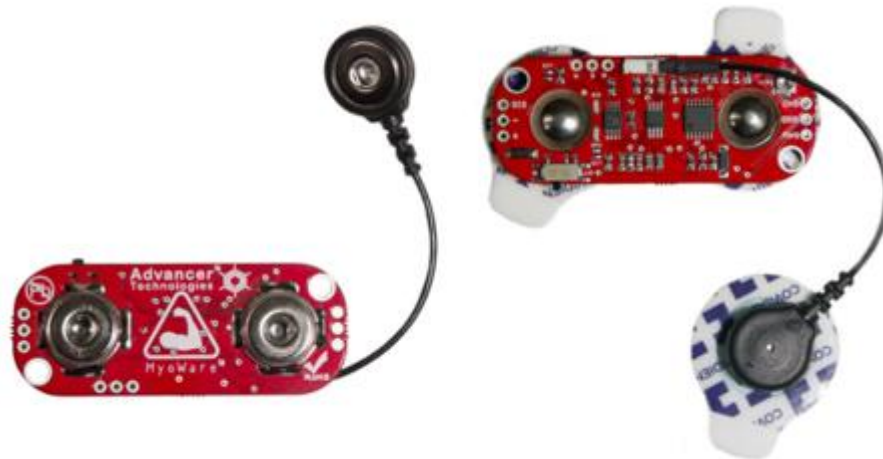
Figura 6 - Sensor Myoware, sem e com eletrodos acoplados.
