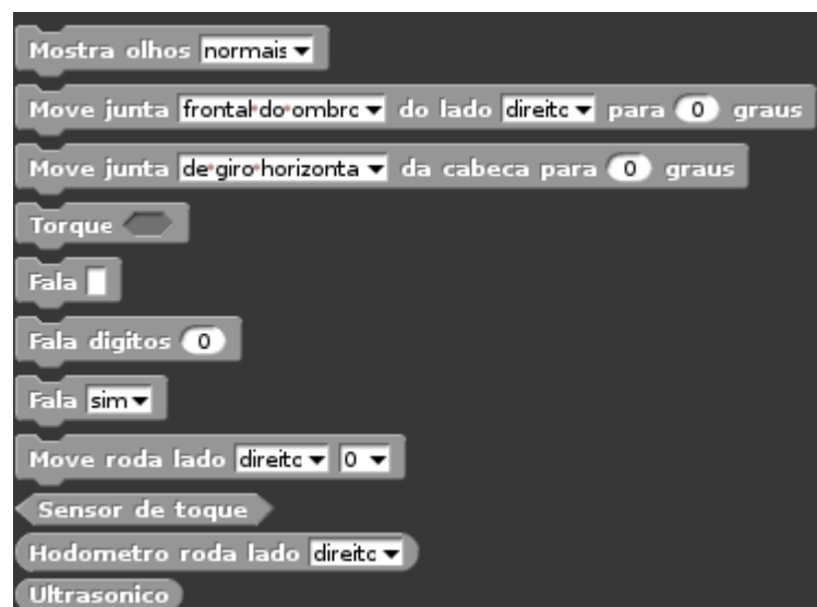
Figura 3.23 – Blocos de controle desenvolvidos para o robô Beo
