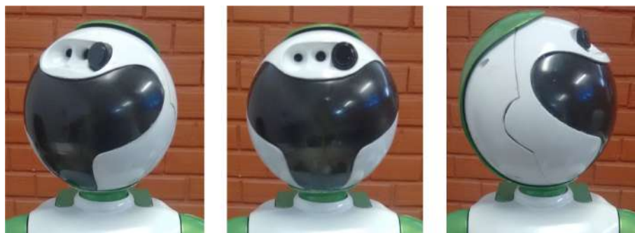
Figura 4.2 – Movimentos ao entorno do eixo Yaw da cabeça
