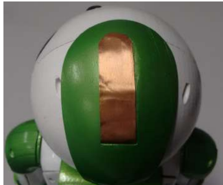
Figura 3.7 – Sensor capacitivo de toque presente na parte superior da cabeça do robô
