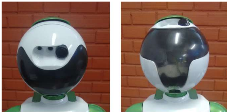
Figura 4.1 – Movimentos ao entorno do eixo Pitch da cabeça
