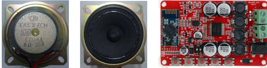
Figura 3.9 – Alto falante e hardware amplificador de áudio com suporte Bluetooth utilizados para reprodução de áudio
