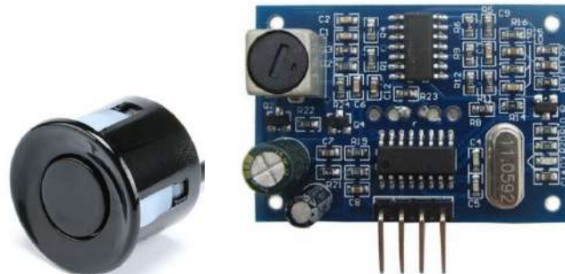
Figura 3.8 – Hardware do sensor ultrassônico utilizado
