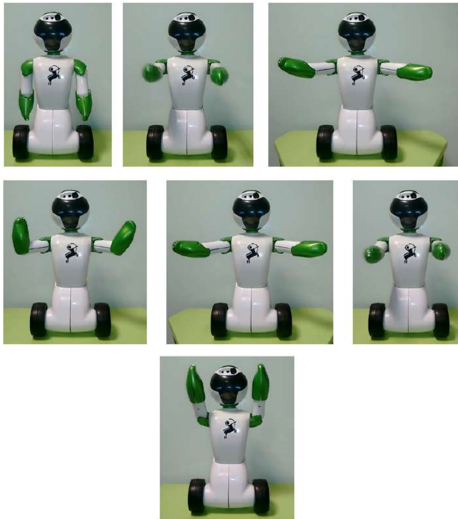
Figura 4.3 – Alguns movimentos dos braços do robô
