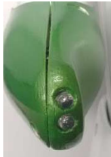
Figura 3.12 – LEDs infravermelhos presentes na extremidade do braço esquerdo do robô
