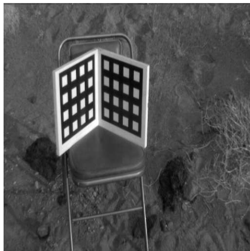
Figura 1: Exemplo de objeto para calibragem baseada em referência 3D.
