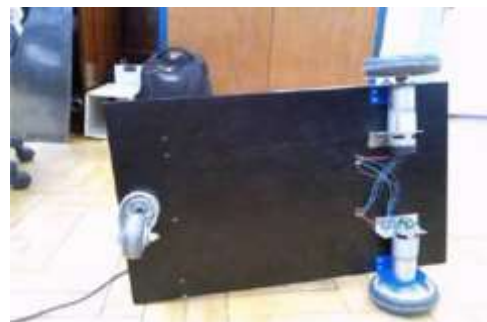
Figura 8 - Parte inferior com motores e encoders montados
