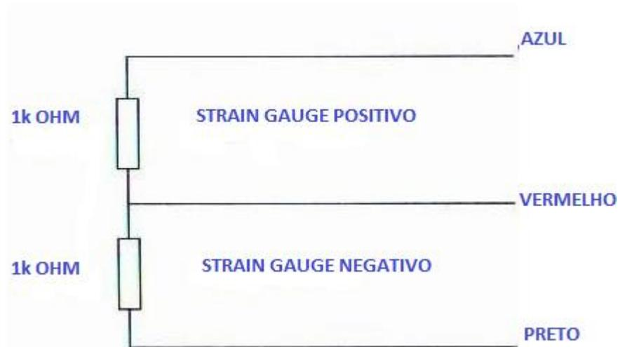
**Figura 18 – Circuito interno da célula de carga.**
