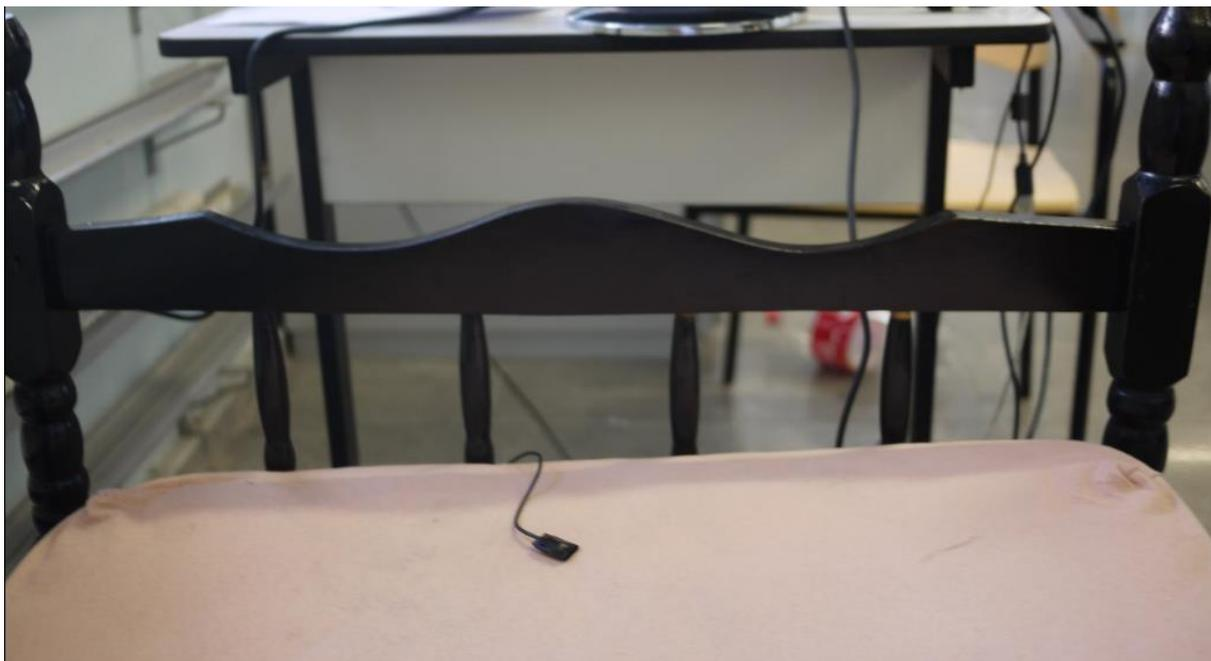
**Figura 30 – Acelerômetro junto à cabeceira da cama.**
