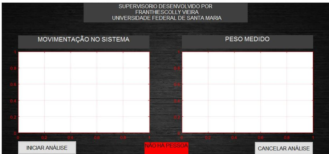
**Figura 26 – Interface primária do sistema supervisorio desenvolvido.**
