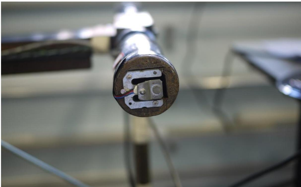
**Figura 29 – Célula de carga fixada no pé da cama.**
